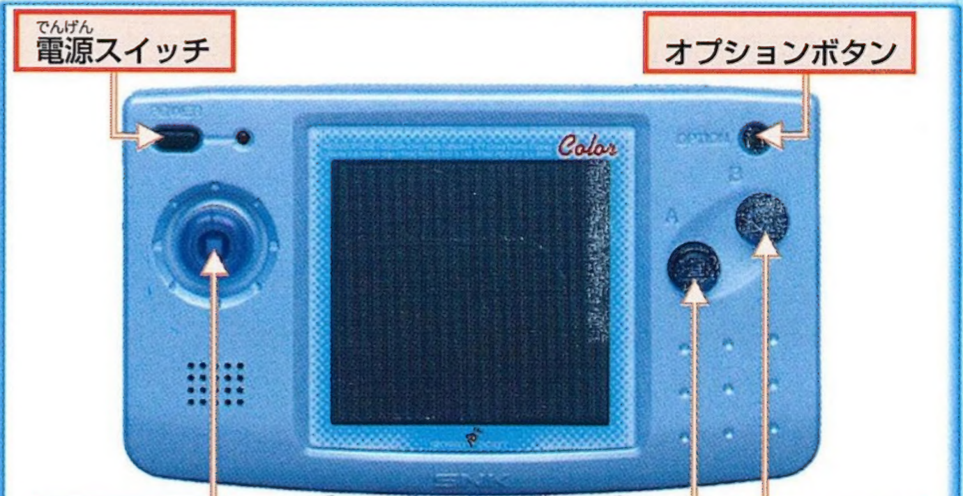
電源スイッチ オプションボタン レバー Aボタン Bボタン
